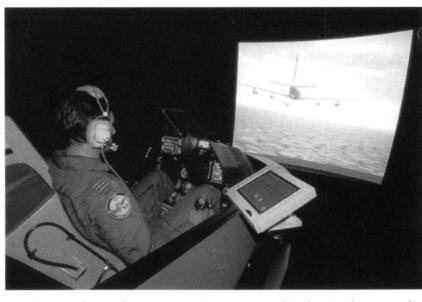
Les drones de combat peuvent être commandés depuis des consoles ressemblant à des simulateurs de vol (ici, le Flight Sim F-16 de Kleine Brogel). Le pilote se trouve à des milliers de kilomètres de son appareil. Toutes les données concernant l'environnement (vue extérieure, image radar,...) sont relayés par satellite.
