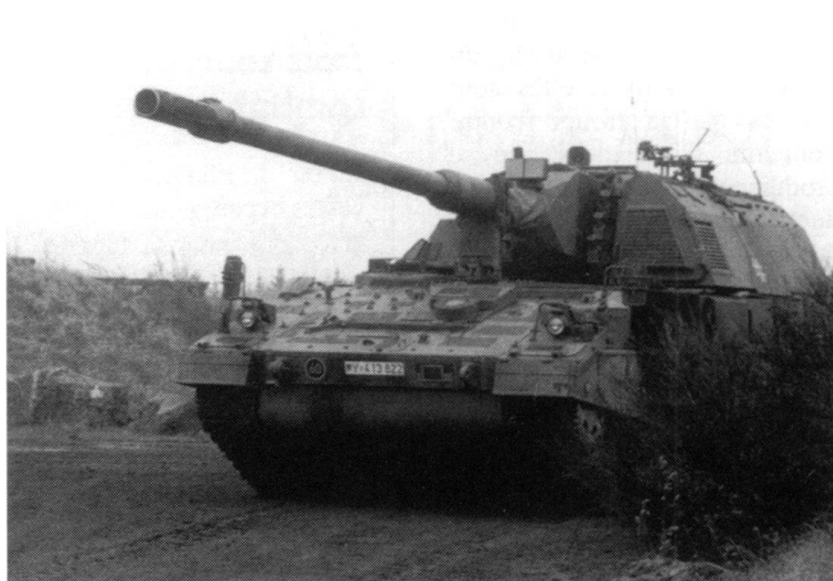
Le Panzerhaubitze 2000 de 155 mm assure l'appui de feu pour les opérations immédiates. Il se caractérise par une grande précision et une grande portée pratique.
