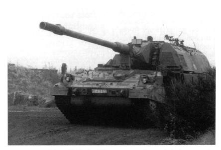
Le Panzerhaubitze 2000 de 155 mm assure l'appui de feu pour les opérations immédiates. Il se caractérise par une grande précision et une grande portée pratique.
