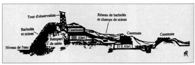
Coupe d'un fortin de la Ligne Bar-Lev. Diagramme réalisé par l'auteur.
