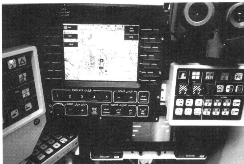
Révolution dans les affaires militaires: tout savoir de ses troupes et de l'ennemi. Ici, la place du commandant sur le char français Leclerc, avec son système d'aide au commandement. (Photo: GIAT Industries)
