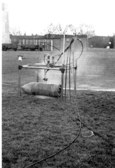
Le DIAJET/Excalibur découpant une bombe grâce au contrôle à distance.
