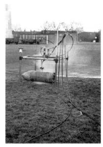
Le DIAJET/Excalibur découpant une bombe grâce au contrôle à distance.
