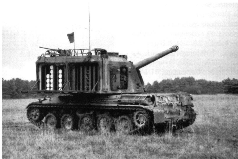
155 AUF-1T en position. Sur l'arrière de la tourelle, les casiers du dispositif de chargement automatique. (Photo: Yves Queloz)
