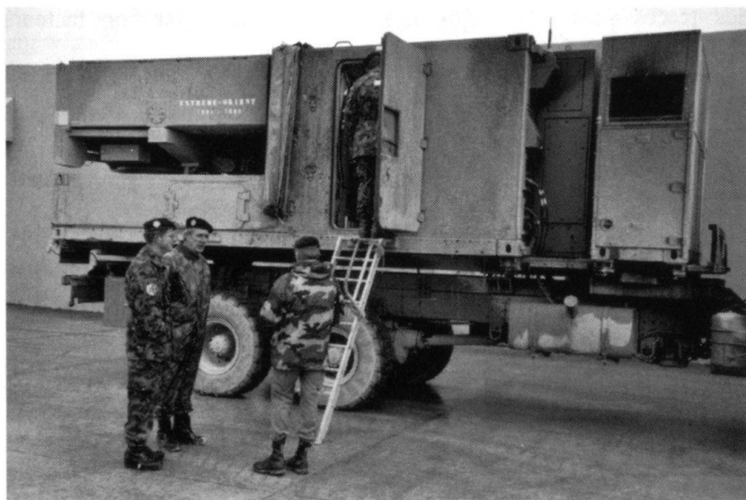
Le système Cobra. Sur l'arrière du véhicule, l'antenne du radar est pliée en position «Mouvement». Au centre, le poste de travail des opérateurs. Comme dans tous les systèmes d'armes hyper-sophistiqués, on n'y découvre rien de spectaculaire: des claviers et des écrans... (Photo: Yves Queloz)
