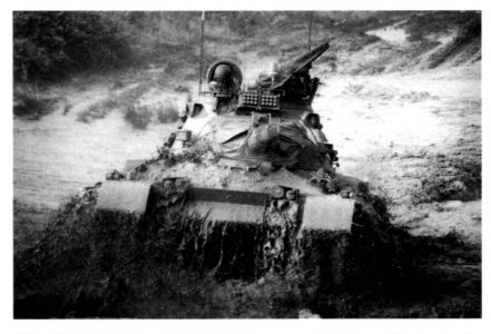
Char 68 dans une mer de boue. Au sommet de la tourelle, le simulateur laser qui permet d'entraîner le duel...
