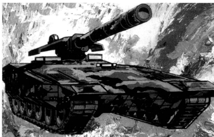
Une solution qui supprime la tourelle compartiment de combat avec équipage.
