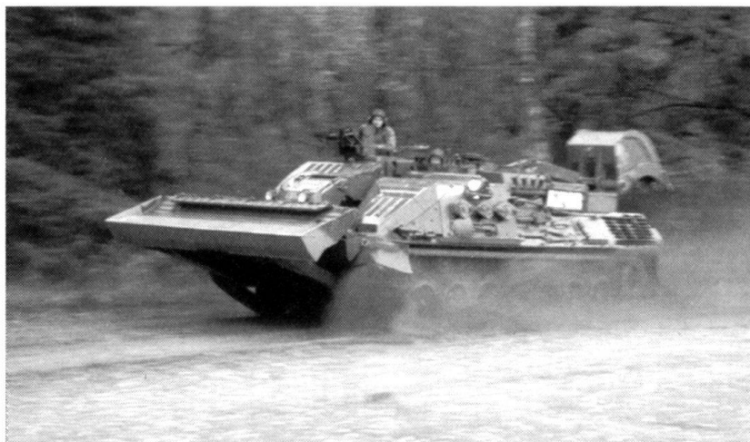
Le char du génie de Moelv/Hägglunds sur châssis Leopard 1.
