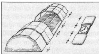
fixes. Le recouvrement en bâches translucides ne nécessitait pas de structure particulière, la structure primaire étant suffisante pour recevoir ce revêtement tenu par tension.
