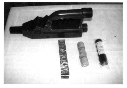
ter des toxiques chimiques de combat dans l'air. Selon le message concernant le programme d'armement 1997, «la détection se fonde sur le principe de la mobilité ionique par spectrométrie. Un échantillon d'air est ainsi aspiré. Une source d'ionisation dans l'appareil produit alors des ions spécifiques. Ceux-ci sont ensuite séparés dans un champ électrique et déclenchent des signaux à la sortie du senseur, qui sont analysés par le logiciel et affichés
