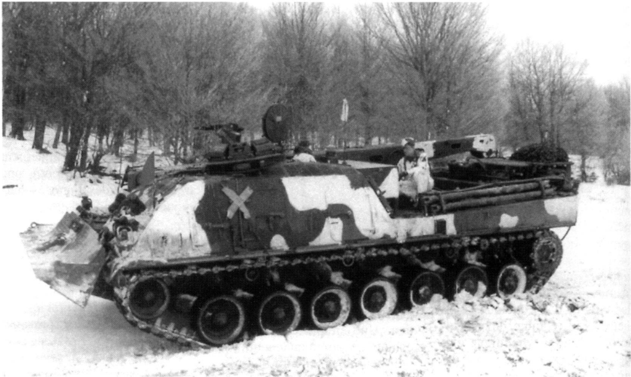
Des engins spéciaux (ici le Büffel, sur châssis de Leopard-2) permettent le dépannage, le franchissement, la construction ou le déblaiement d'obstacles: sur eux repose en grande partie la mobilité des formations mécanisées.
