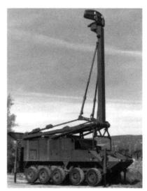
Le radar Giraffe en position d'observation à 10 mètres. (Photo: Mowag)
