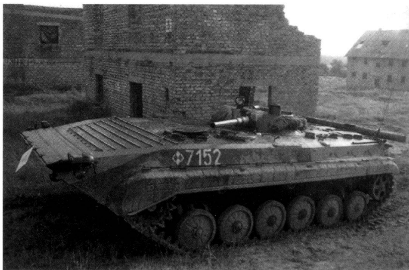
Le BMP-1, en manœuvre sur un terrain d'exercice polonais. Il est ici équipé d'un canon de 73 mm et d'un missile antichar Sagger .
