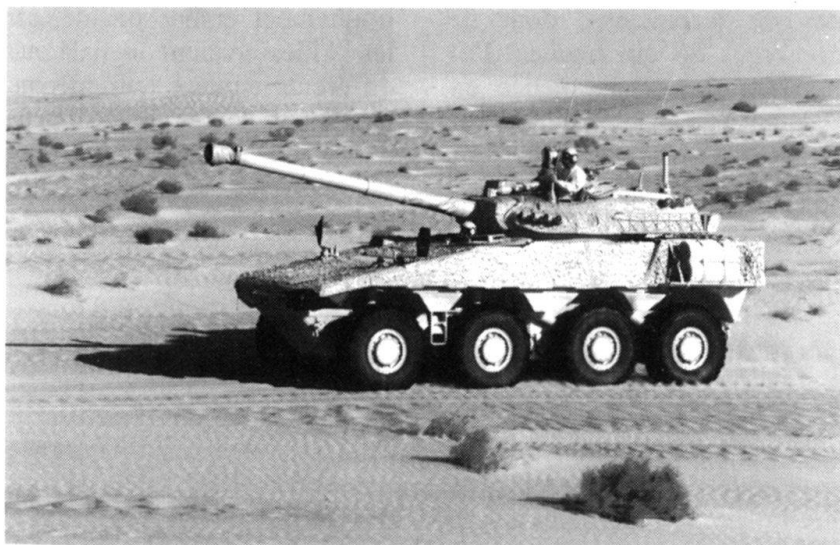
Le démonstrateur Vextra continue d'étonner par sa remarquable mobilité dans le terrain (Ici avec tourelle TML 105 OTAN, apte au tir en marche. La motorisation de la tourelle est un produit SIG). (Photo: GIAT Industries).
