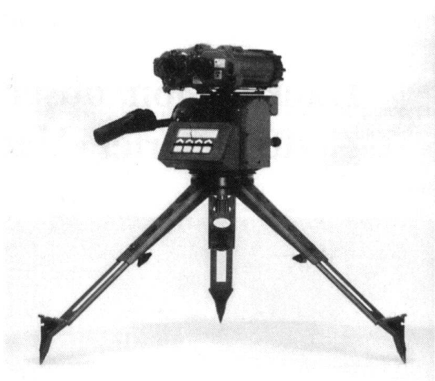
Goniomètre numérique SG12F, avec télémètre laser: l'outil de l'observateur d'artillerie (Photo Leica Geosystems AG).
