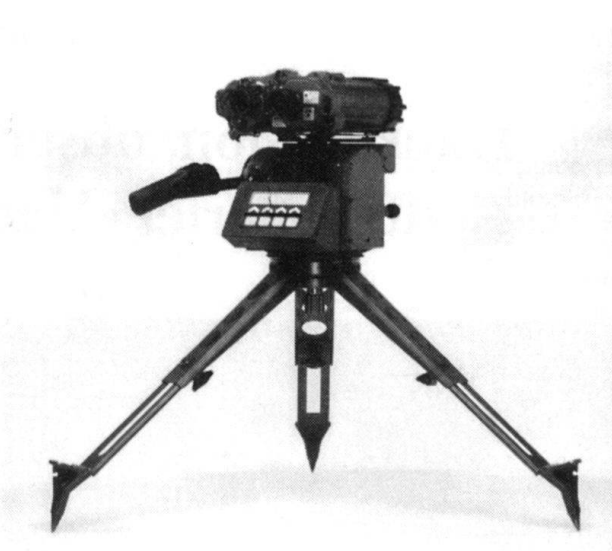
Goniomètre numérique SG12F, avec télémètre laser: l'outil de l'observateur d'artillerie (Photo Leica Geosystems AG).
