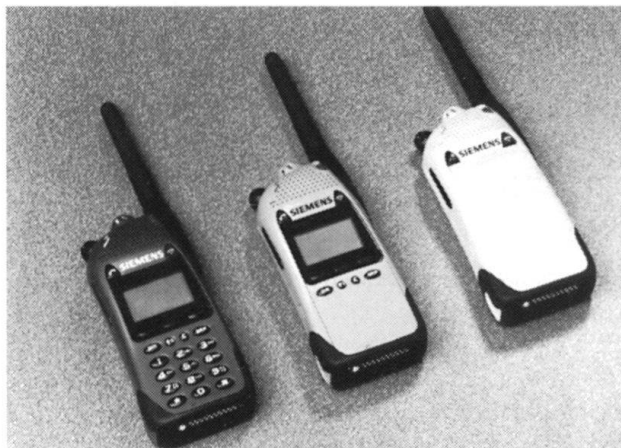
Les terminaux TETRAPOL, entre téléphone portable et appareil radio (Photo: Siemens Switzerland Ltd).
