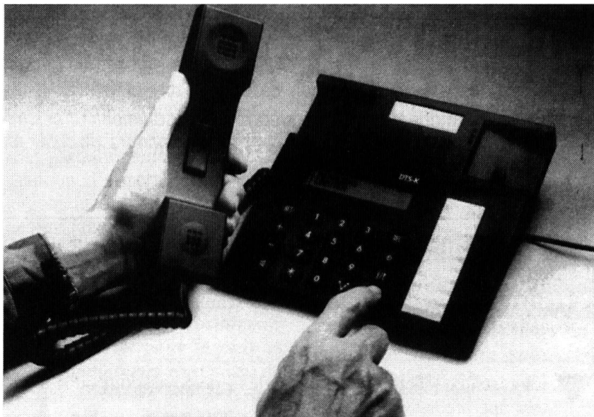
Le modèle conçu pour l'engagement militaire dans un abri, le DTS-K, est basé sur la conception civile. Tout en disposant des mêmes fonctions que le DTS-G, le modèle est moins cher.
