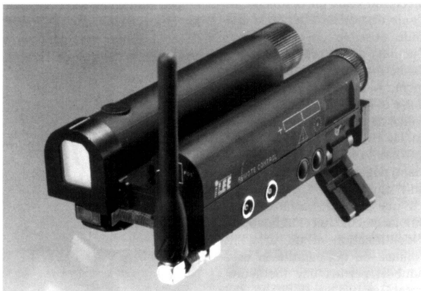
L'unité laser est montée sur le centre de gravité de l'arme (Photo: Oerlikon Contraves Defence).
