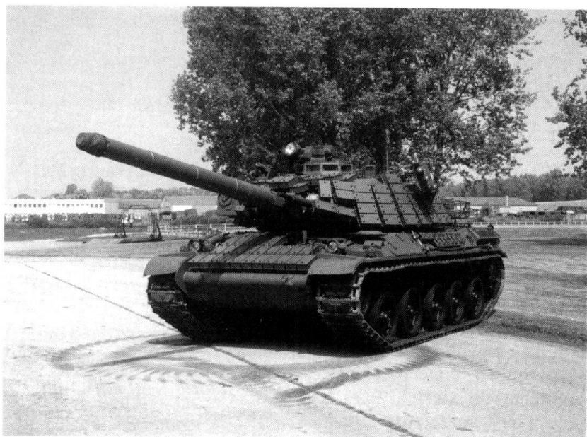
Sur la tourelle et l'avant de cet AMX-30, du blindage réactif, une protection passive (Photo: GIAT Industries).
