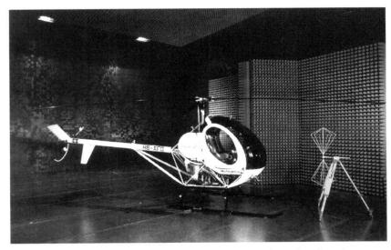
Mesure de perturbations électromagnétiques dans la chambre anechoique de Montena emc. (Photo: Montena emc)
