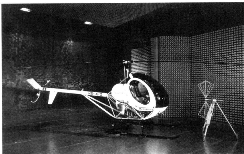
Mesure de perturbations électromagnétiques dans la chambre anechoïque de Montena emc. (Photo: Montena emc)
