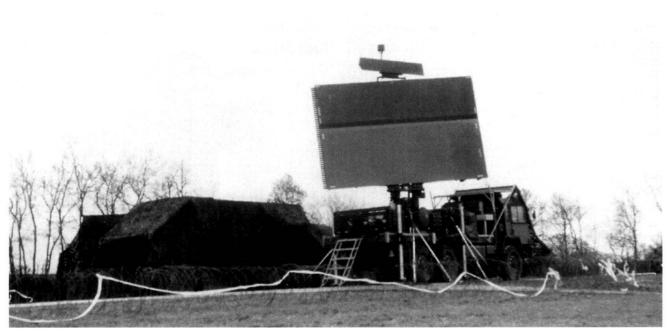
Station mobile équipée d'un radar Taflir.
