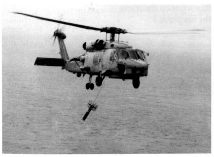
Sonar héliporté de basse fréquence pour la détection de sous-marins, développé par la firme Hughes en collaboration avec Thomson Sintra Activités sous-marines (Photo: Hughes).
