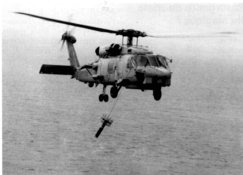
Sonar héliporté de basse fréquence pour la détection de sous-marins, développé par la firme Hughes en collaboration avec Thomson Sintra Activités sous-marines (Photo: Hughes).
