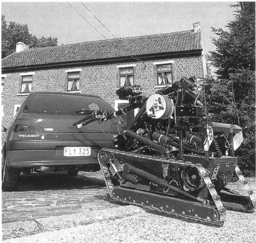
Lutte contre le terrorisme : le robot commandé à distance permet d'approcher sans risque les véhicules suspects.
