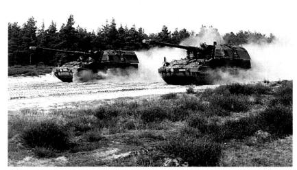
Le PzH 2000 est capable de vitesses supérieures à 60 km/h (Photo : Wegmann).
