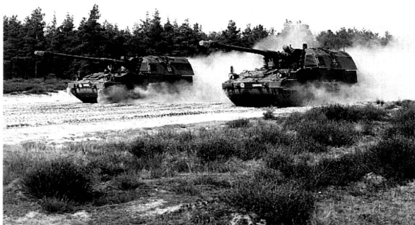
Le PzH 2000 est capable de vitesses supérieures à 60 km/h (Photo : Wegmann).
