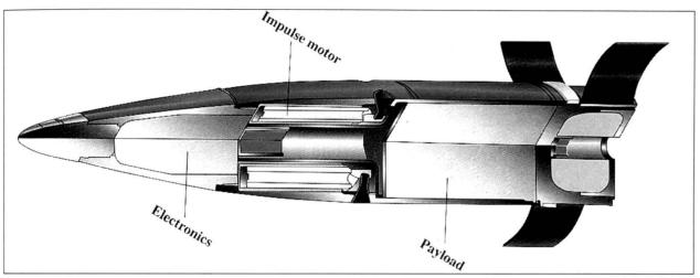
L'obus TCM de 155 mm comprend un système de guidage, si bien que la trajectoire peut être corrigée pendant le vol, annulant les effets des variations de vitesse initiale, des différences d'élévation et de site, des changements de conditions météorologiques.
