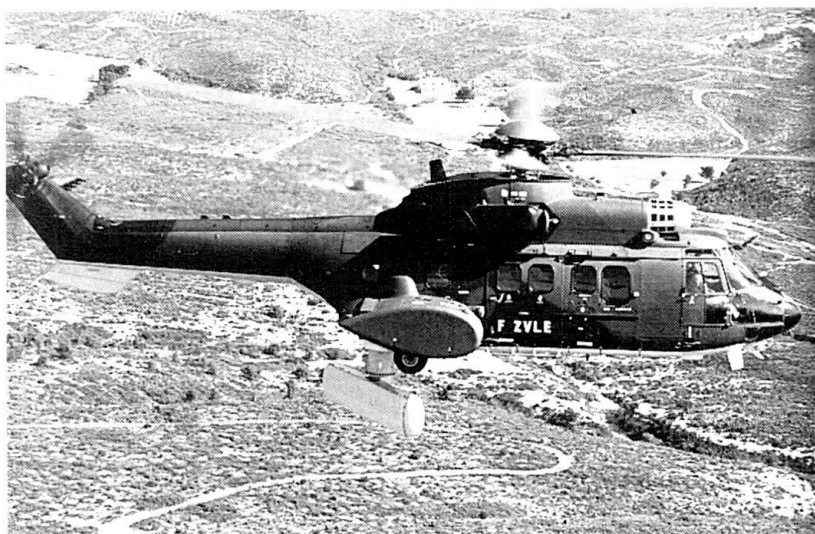
Un hélicoptère Cougar avec l'antenne radar déployée (photo : J. Deulin).
