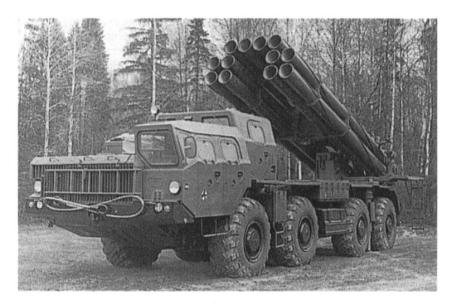
d'Etat russe, le lance-roquettes multiples de 300 mm *SMERCH* n'était pas le moins imposant. Les 12 tubes sont montés sur un châssis *MAZ-53M*, le tout pesant près de 44 tonnes. La fusée mesure 7,60 mètres et pèse près de 800 kg. Une salve complète est tirée en moins de 40 secondes à une distance de 20 à 70 kilomètres, balayant un carré d'un peu plus de 800 mètres de côté.
