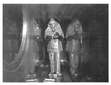
Vue intérieure du tunnel d'essais dynamiques de CEB, pour l'étude du comportement en dynamique et sous atmosphère toxique de moyens de protection et de détection (Photo : DGA/ET CA/CEB).
