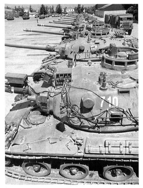
Les équipages s'entraînent sur des simulateurs en salle comme l'ELSA à Thoune; ils peuvent également disposer de simulateurs montés sur leur «vrai» qui permet de « tirer », de «toucher» et de «détruire» un adversaire: le moteur peut être coupé et le feu tournant s'enclenche. Au premier plan, un AMX-30 de l'armée française équipé d'un tel simulateur.
