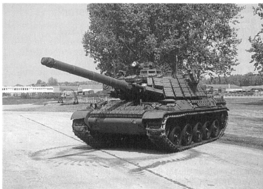
Un AMX-30 équipé d'une surprotection réactive Brenus adaptable sur tout véhicule blindé (Photo : GIAT Industries).
