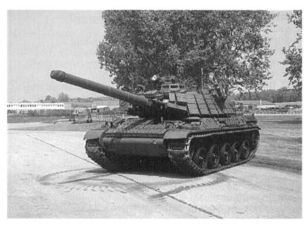
Un AMX-30 équipé d'une surprotection réactive Brenus adaptable sur tout véhicule blindé (Photo : GIAT Industries).
