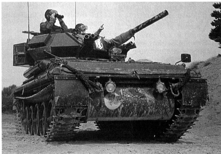
Le char d'exploration Scorpion équipé d'un canon de 76 mm. Poids : 8 tonnes. Vitesse de pointe : 90 km/h.
