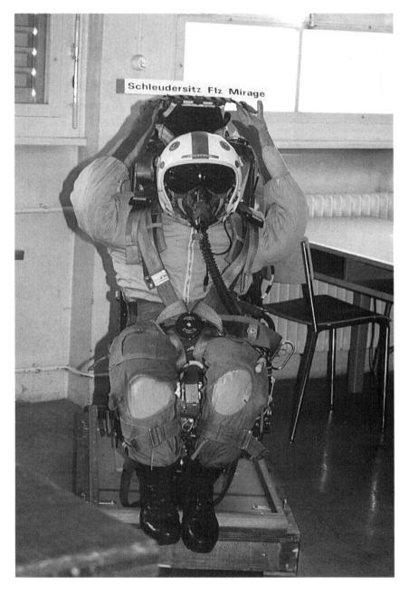
d'éjection. Les arêtes du coffret appuie-tête brisent le toit de la cabine. Le pilote a néanmoins la possibilité de larguer le toit avant de s'éjecter. Avant que le tube ne se sépare de l'avion, un dispositif à cartouches, actionné par une drisse d'amorçage, met à feu la fusée
