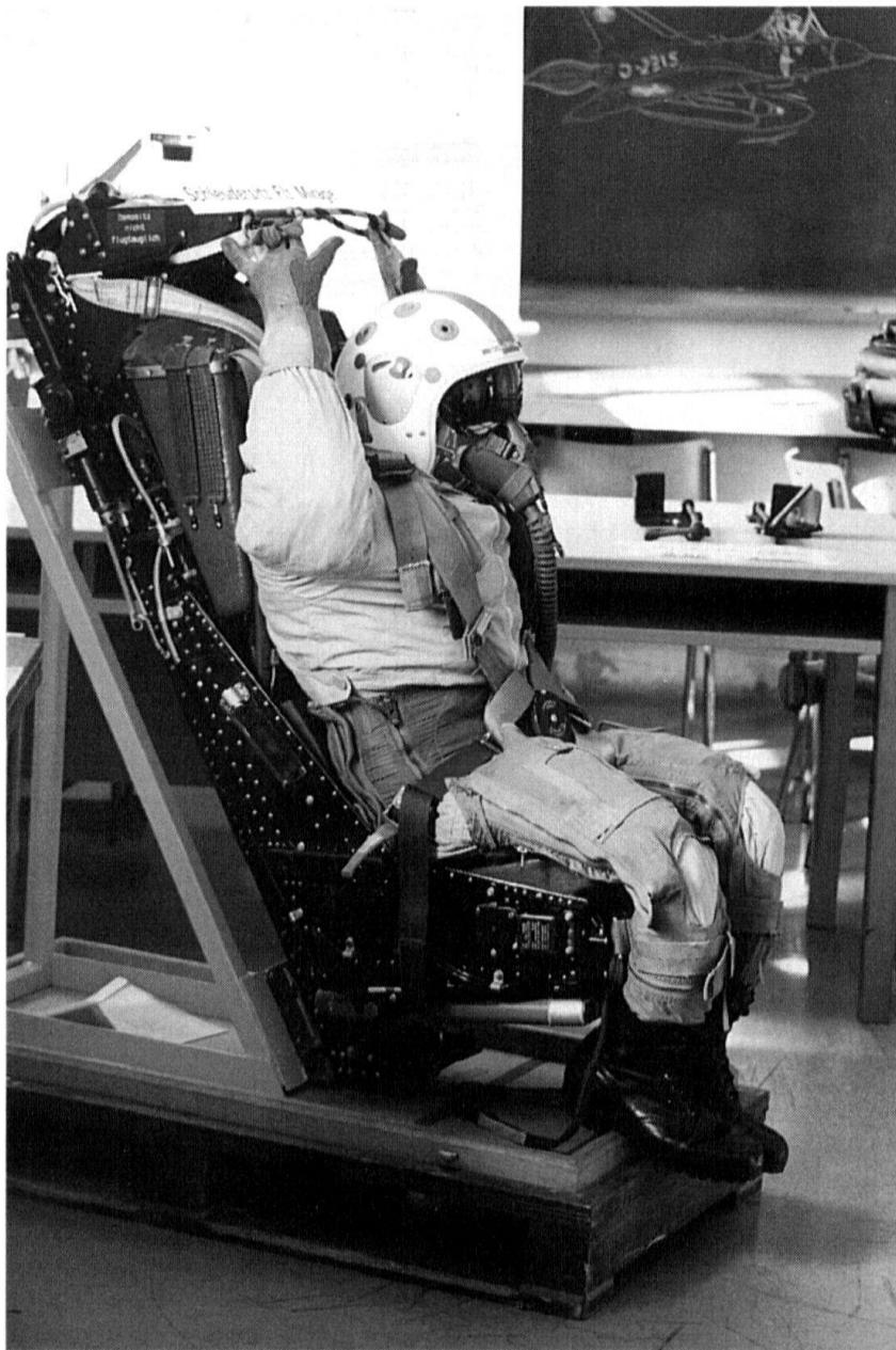
gles de rappel appliquent fortement les jambes du pilote au baquet, un fil de lin déclenche le signal de dé-tresse IFF, la radio de bord et l'alimentation en oxygène se séparent. L'installation de secours alimente alors le pilote jusqu'à sa séparation d'avec le siège.
