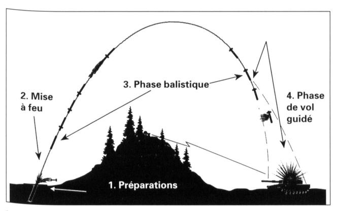
Munition de lance-mines de 12 cm (principe de fonctionnement).
