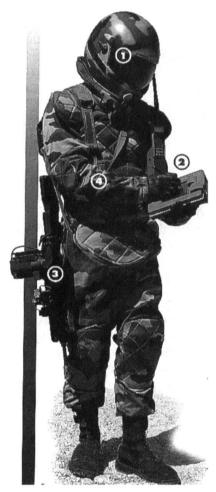
Le système du combattant, mis au point par un consortium d'entreprises françaises. 1. Le casque qui intègre protection balistique, caméra video, protection AC, etc. 2. L'électronique qui comprend une radio tactique, un système de navigation, un système de transmission des données et des capteurs physiologiques. 3. La conduite de tir pour l'arme individuelle. 4. La tenue de combat climatisée offrant protection balistique et AC.
