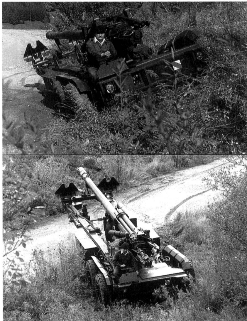
Equipée d'un moteur Porsche de 120 CV, la version autopropulsée change de position sans véhicule tracteur.
