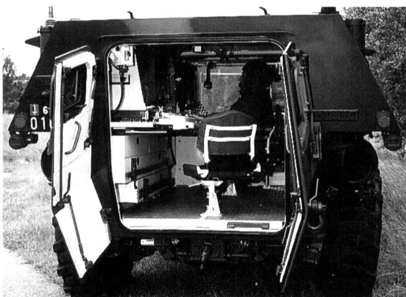
Console SIR installée dans un Véhicule de l'Avant Blindé (VAB), comme poste de commandement régimentaire (niveau bataillon pour la Suisse). (Photo : Matra CAP Systèmes).
