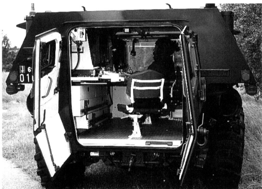
Console SIR installée dans un Véhicule de l'Avant Blindé (VAB), comme poste de commandement régimentaire (niveau bataillon pour la Suisse). (Photo : Matra CAP Systèmes).
