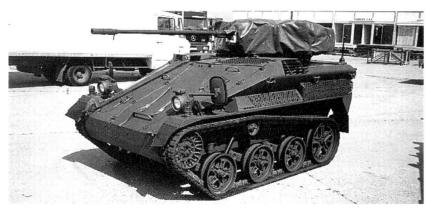
porteurs, 1 galet-support, 1 barbotin à l'avant, une poulie de renvoi à l'arrière à la hauteur des galets porteurs. Les chenilles sont des rubans de caoutchouc d'un seul tenant. La suspension est à barres de torsion, amortisseurs hydrauliques et butées de fin de course.
