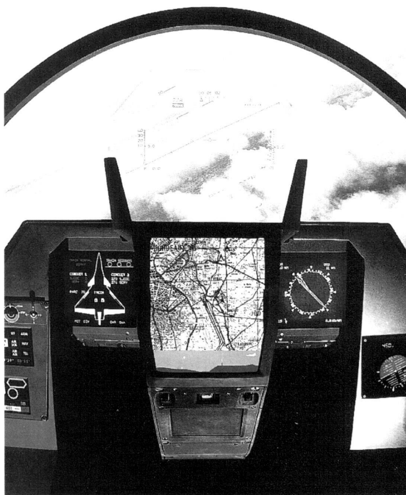
«Planche de bord du Rafale. Un viseur tête haute, un écran tête moyenne et deux écrans tactiles latéraux.» (Photo Sextant Avionique/Palette).
