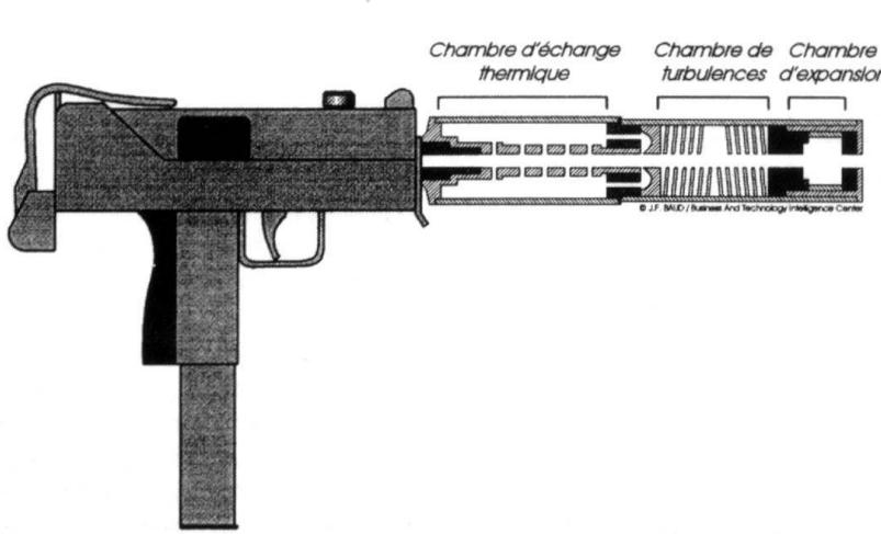
des matériaux joue un rôle important sur la durée de vie du silencieux. En effet, il est soumis à des contraintes mécaniques et thermiques importantes et il devrait conserver ses propriétés sans exiger des travaux d'entretien trop fréquents.
