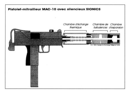
des matériaux joue un rôle important sur la durée de vie du silencieux. En effet, il est soumis à des contraintes mécaniques et thermiques importantes et il devrait conserver ses propriétés sans exiger des travaux d'entretien trop fréquents.
