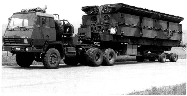
Pont flottant motorisé 95. Module de pont chargé sur camion.
