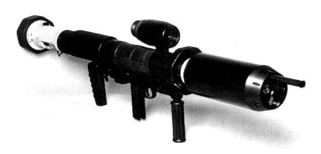
Le simulateur de tir pour le Panzerfaust fonctionne sur la base du laser comme celui du Dragon, du Tow et du Fusil d'assaut 90. Il permet une instruction de base réaliste jusqu'à l'échelon du groupe.
