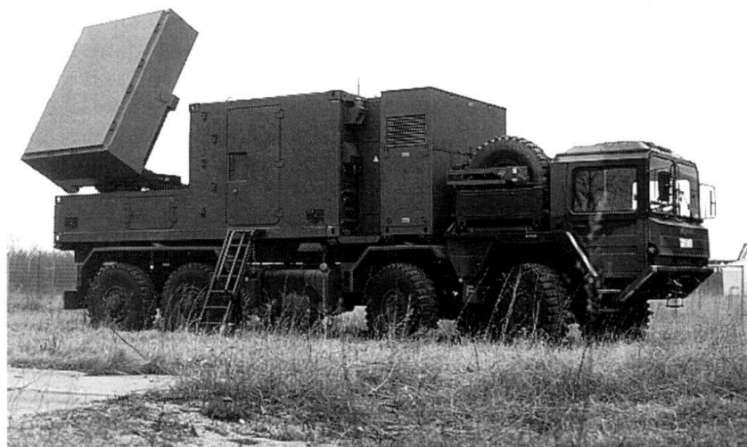
COBRA: Counter Battery Radar/radar de contre-batterie, champ de bataille à état solide et antenne active (Photo Thomson-CSF).
