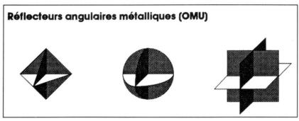
Les Russes ont développé toute une série de formes de réflecteurs angulaires qui peuvent être réalisés par la troupe avec des moyens de fortune. Ces réflecteurs peuvent être disposés de sorte à offrir la signature radar d'un char d'une station radar ou d'un poste de commandement mobile. brun et noir). Obéissant à des spécifications strictes, ces couleurs contiennent un pigment qui réfléchit le rayonnement IR naturel de manière analogue à la végétation.
