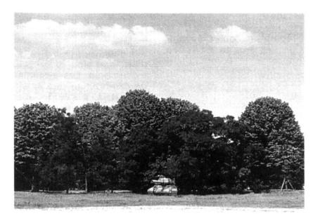
Leurre en deux dimensions (2D). Il s'agit d'un panneau représentant un char AMX-30. Il pèse 45 kg et peut être mis en place en 15 minutes. Des sources de chaleur aux chenilles et à l'emplacement du pilote permettent de lui donner une signature thermique similaire à l'original.
