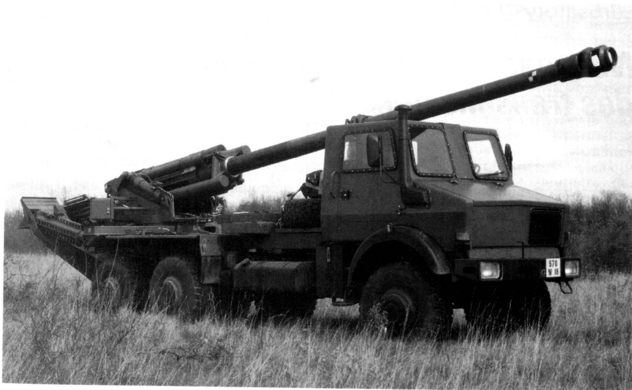
La mobilité à tout prix. Le Caesar est une pièce de 155 mm montée sur un châssis de camion Unimog (Photo GIAT Industries).
