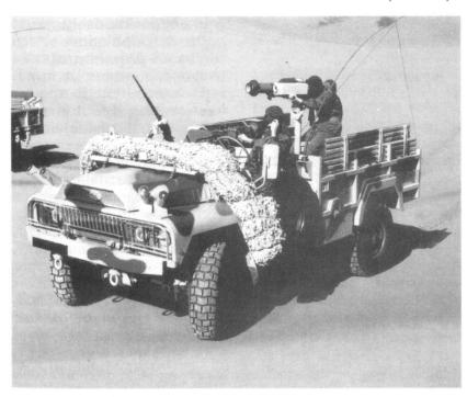
Véhicule léger de reconnaissance et d'appui (VLRA), version «Milan» et mitrailleuse 12,7 (Photo ACMAT).
