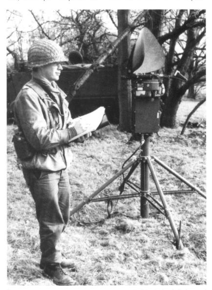
Radar de surveillance du champ de bataille EL/M2130A, réalisé en collaboration par la Belgique et Israël...
