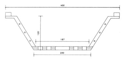
Plan d'une coupe d'un élément de caisson.
