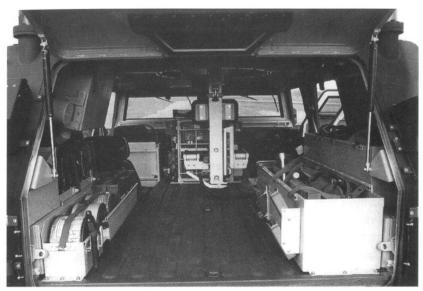
Vue de l'intérieur du véhicule. A gauche, les bobines de fil pour les liaisons téléphoniques et la munition. A droite, l'outillage de bord. Au centre, le support du siège de l'observateur qui peut être tourné de manière à dégager l'espace suffisant pour une civière. [Photo Mowag]
