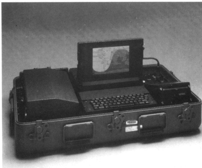
Conçu pour les Forces spéciales US opérant dans la profondeur du territoire adverse, le Système de communication léger déployable (LDC-1) a été testé avec succès lors de la guerre du Golfe. Il comprend un laptop Gridset 386, une imprimante et un lecteur de disquette, à l'engagement, il est couplé à un système de transmission satellite. (photo SAIC)
