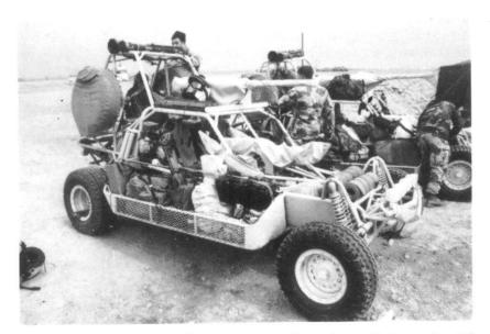
Le Light Strike Vehicle (LSV) dans la configuration utilisée par les US Marines Recon Teams (avec 1 mitrailleuse M2 HB de 12,7 mm et 1 mitrailleuse M60E3 de 7,62 mm) pour l'exploration en profondeur. Léger, rapide (130 km/h), très maniable et offrant une signature radar et thermique minimales, le LSV peut évoluer facilement en territoire ennemi. Depuis la guerre du Golfe, les forces spéciales britanniques (SAS), portugaises et françaises se sont équipées de véhicules similaires. (Photo Chenowth)
