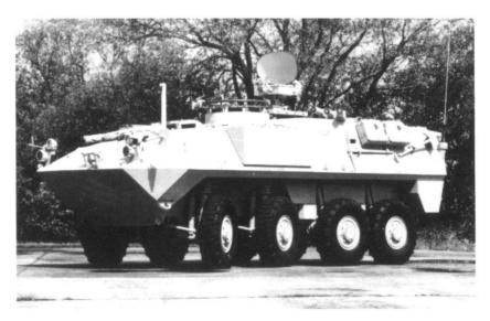
Le radar Rasit sur Piranha 8x8, un exemple d'utilisation compatible avec les matériels déjà en service dans l'armée suisse. Un tel montage serait possible sur le véhicule d'exploration 93, par exemple, avec une représentation graphique automatique – sur carte – de l'image radar. (Photo Thomson)
