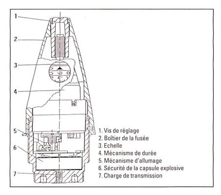
fusée d'impact est à haute sensibilité et réagit au moindre freinage déjà, par exemple dans la neige. La vitesse lors de l'impact de la submunition en chute libre est de 40 à 50 mètres à la seconde.
