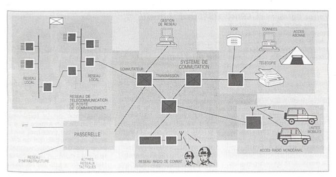
Exemple de réseau avec le système intégré Tactique de Communication – Alcatel 101. (Illustration Alcatel)
